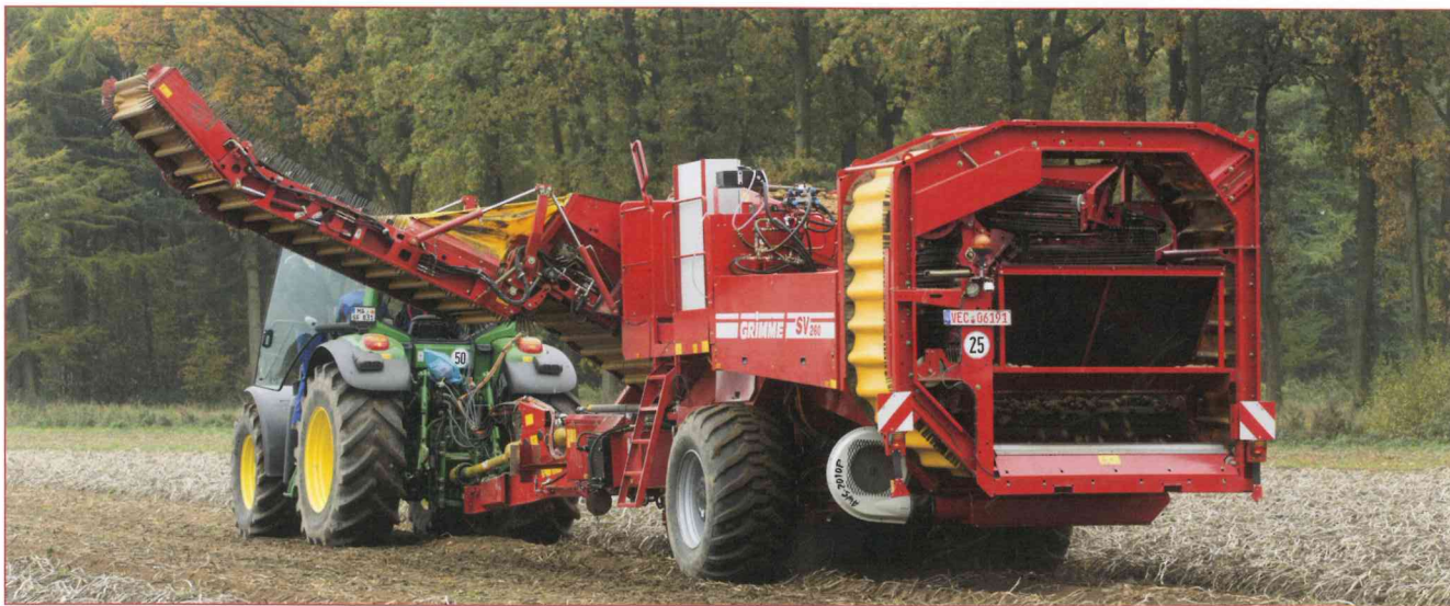
Geregelter Radantrieb am Kartoffelernter im Einsatz auf dem Acker.
