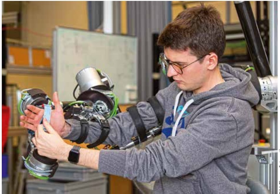
Labormitarbeiter beim Testen des Therapieroboters AnyExo.
